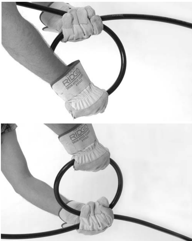
Figura 15 – Giro de la manguera para que logre atravesar un atasco
