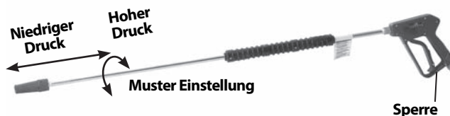
Abbildung 17 – Einstellungen der Waschlanze-Düse
