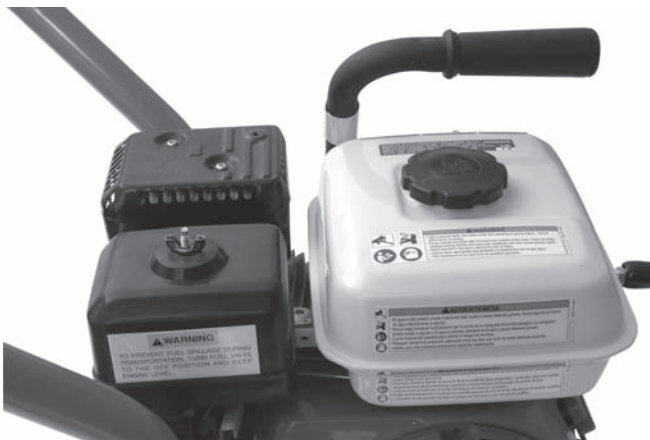
Slika 6B – KJ-2200 Upozoravajuće nalepnice
