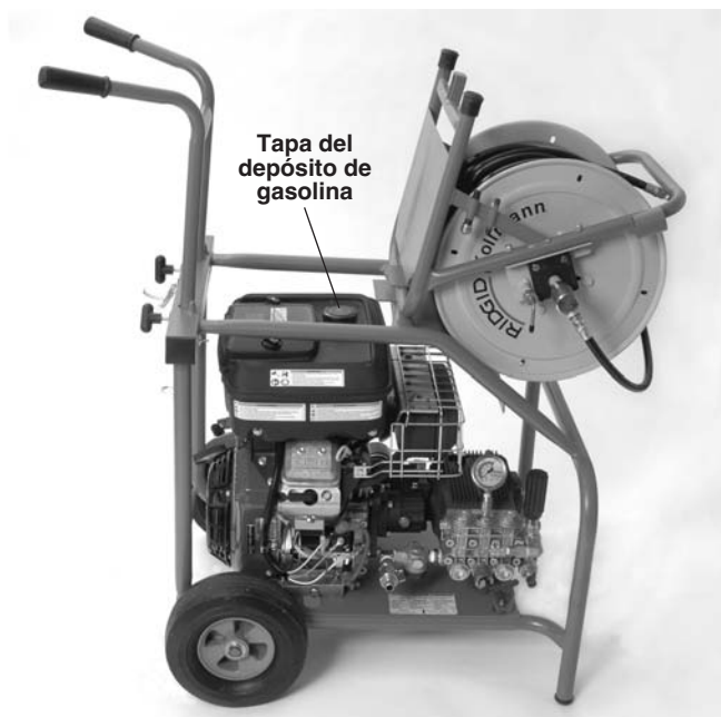
Figura 8 – Acceso al depósito de gasolina de la KJ-3100
