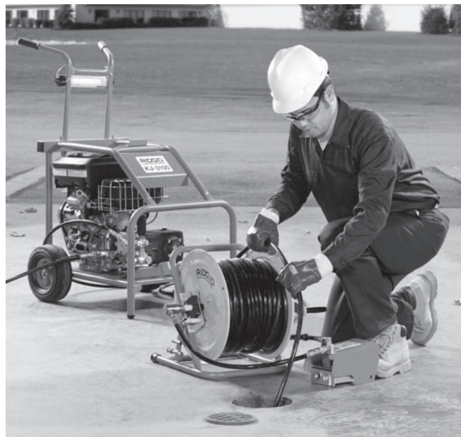
Figura 14 - Poziția corectă de exploatare
