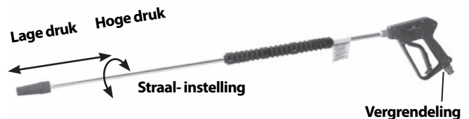
Figuur 17 – Instellen van de spuitlanssproeikop
